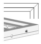
f. Fixieren Sie den Eckwinkel mit Hilfe des Innensechskantschlüssels. Dazu haben die Profile an den Außenseiten Löcher. Diese führen genau zu den Madenschrauben, die in den Eckwinkeln vormontiert sind und den Rahmen somit zusammenhalten.
