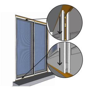
Schieben Sie den unteren Teil des Flügels Richtung Montagerahmen, bis er sich über der vorderen Schiene befindet.
