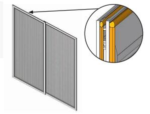
Setzen Sie den Flügel oben in den Montagerahmen ein, so dass er in der vorderen Schiene Halt findet.
