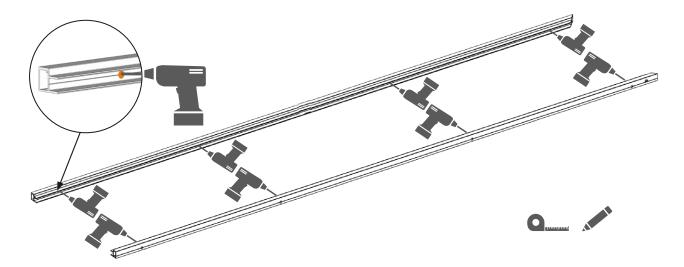
Bei größeren Türen oder bei Bedarf sollten Sie auch das obere horizontale Profil mit 3 bis 4 Bohrlöchern versehen.
