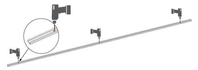
c. Bohren Sie nun an den markierten Stellen alle markierten Profile sowie die Laufschiene einmal komplett durch.
