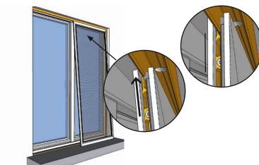
Setzen Sie ihn oben in den Montagerahmen ein, so dass er in der hinteren Führungsschiene Halt findet.
