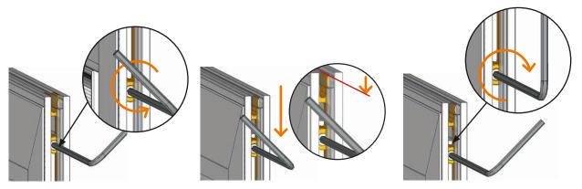
Aushängesicherungen lösen, um ca. 2 mm nach unten schieben und fixieren.
